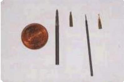
特にシャープペン先金具は4段、5段の穴をもっているため、超硬の丸棒から刃物を加工します。
